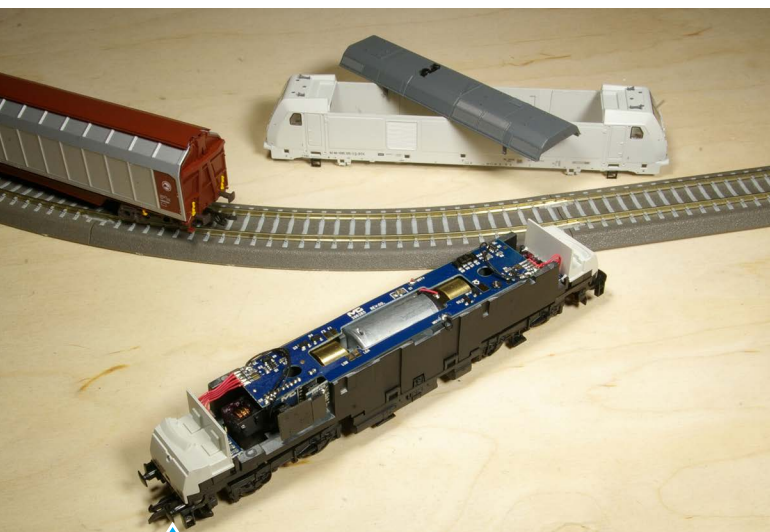
A moduláris felépítésű mozdony elektronikája teljes értékű, Plux12-es dekóderrel könnyedén digitalizálható
