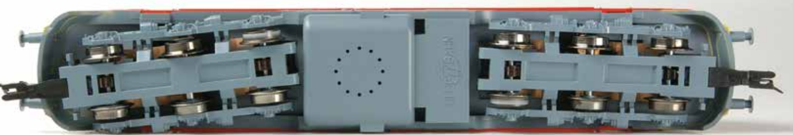
▲ A jól bevált futómű, a most már nem törekeny forgóvázmű és a hangszóró helye a tankimitációban
